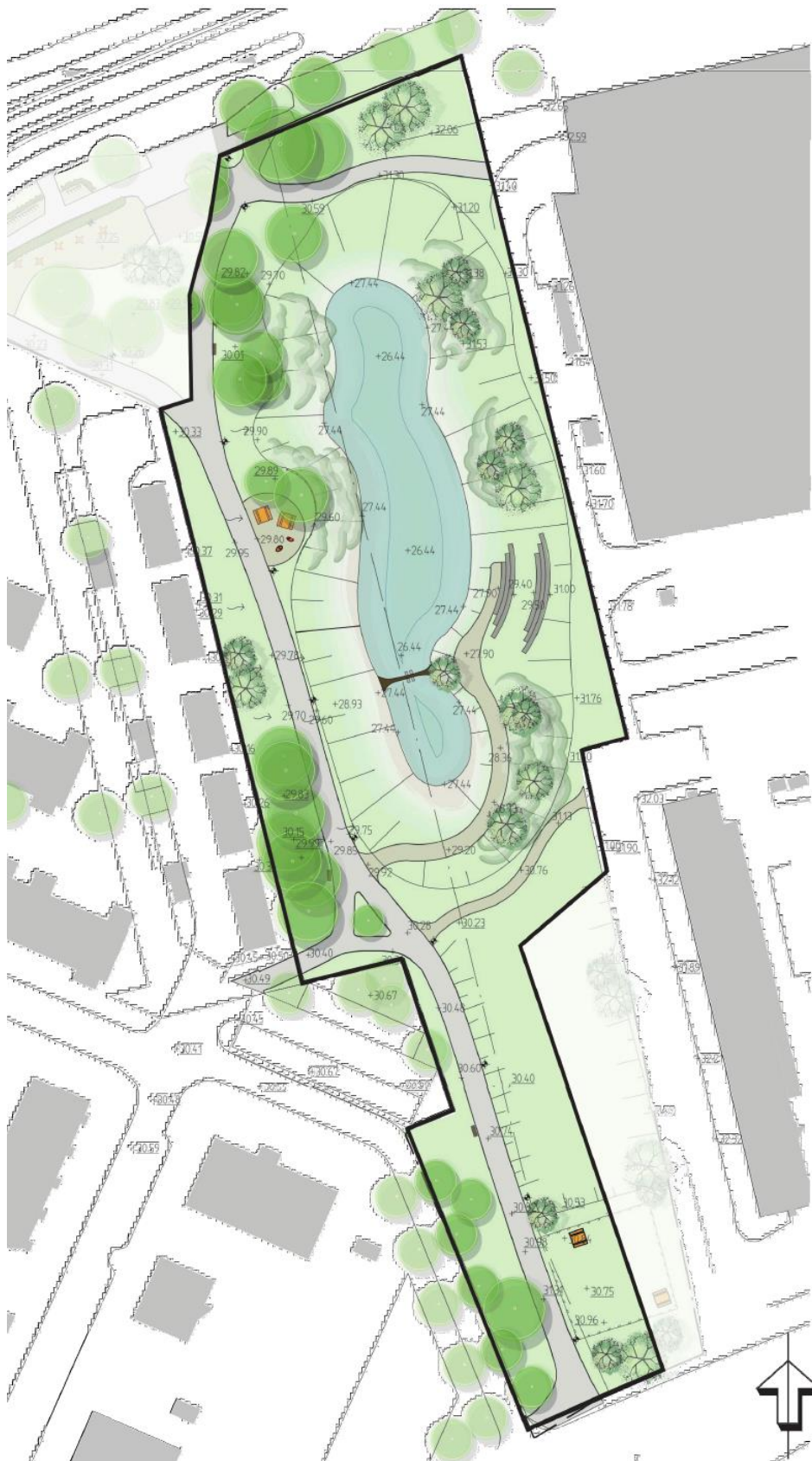
Figur 2. Planillustration av den planerade dagvattendammen.
