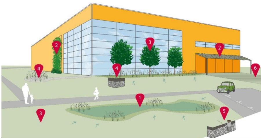
Figur 1a och 1b. Exempel på olika åtgärder som kan vidtas för att hantera mindre regn inom ett flerfamiljshus och en industribyggnad. För förklaring av siffror se tabell 2.
