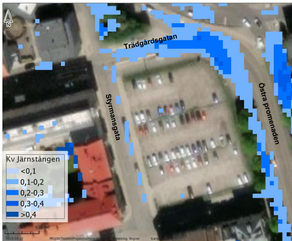
Figur 11. Resultat från skyfallsanalys 100-årsregn som visar maxdjup i meter (PM Nodra, 2023).
