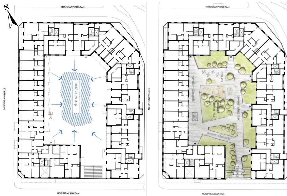
Figur 13. Illustrationsskiss som visar yta tillgänglig för fördröjning samt hur innegården kan tänkas utformas.
