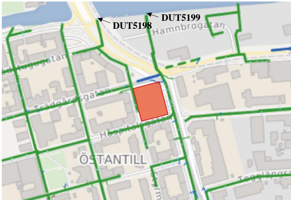
Figur 6. Figur tagen från PM Nodra (2023) som visar dagvattensystem inom området och berörda utlopp (PM Nodra, 2023).
