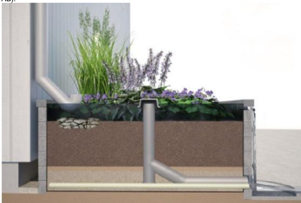
Figur 18. Principskiss av en upphöjd regnbädd intill fasad (Haninge kommun, 2016).
