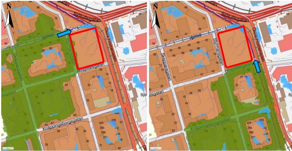
Figur 4. Avrinningsområde och avvattningsvägar med förtydligande av riktning med pil för område uppströms lågpunkten.
