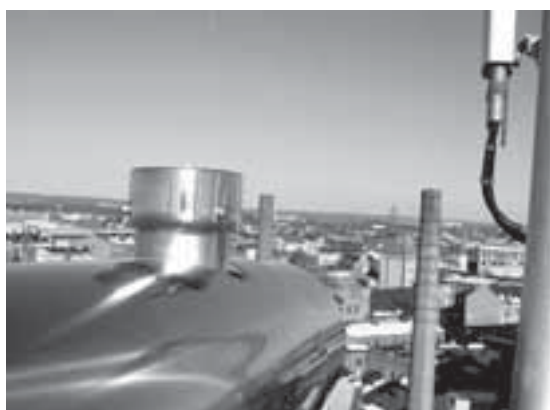
Luftmätningar över innerstaden. På bilden syns sändaren på ProNova som sänder en ljustråle till mottagaren på Rosen 1127 meter bort.
