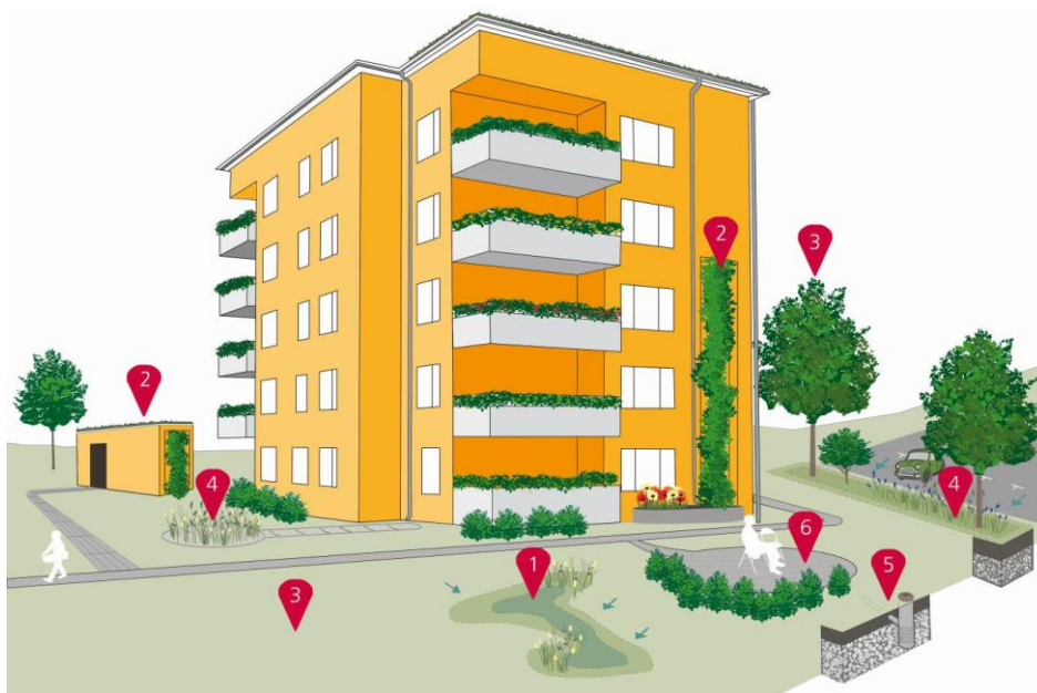
Figur 13 Exempel på olika åtgärder som kan vidtas för att hantera mindre regn inom fastigheten. För förklaring av siffror se Tabell 5.
