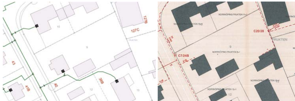
Bild 1: Karta, där de gröna linjerna visar befintligt fjärrvärmenät. Bild 2: De röda linjerna visar befintligt telenät. (Bildkälla: E.ON Värme Sverige AB respektive Skanova)
