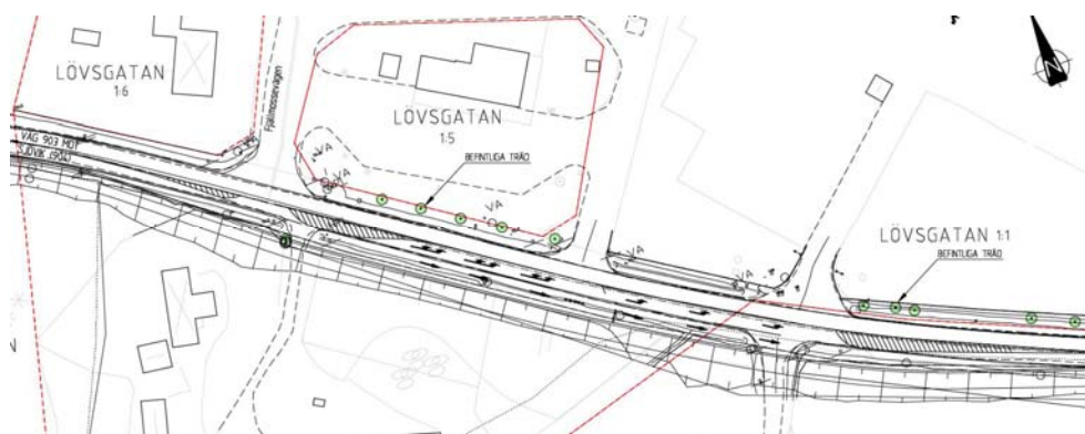
Vänstersvängsfält och dubbla infarter mot huvudparkeringen från väg 903 (åtgärd nr 3). Ramböll 2017.
